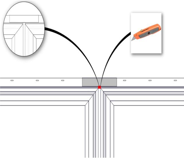
Remueve todas las aletas clavadas si no han sido removidas de fábrica. Si se aplica BMC en la unidad asegúrate de cortar la unión el borde superior e inferior para que el BMC se ajuste en el corte.
