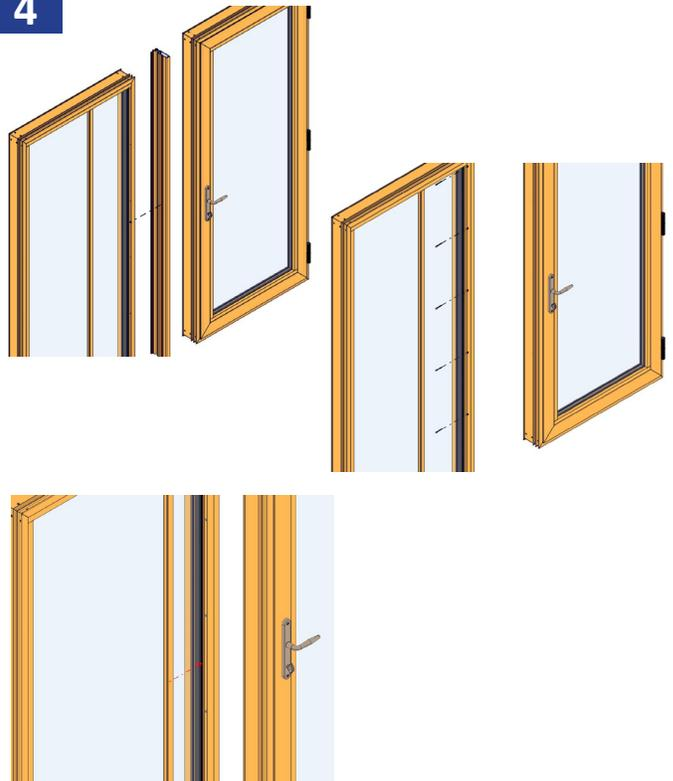
Ajusta el parteluz a los lados de la jamba utilizando los tornillos # 8 de 1 ¼ ".
