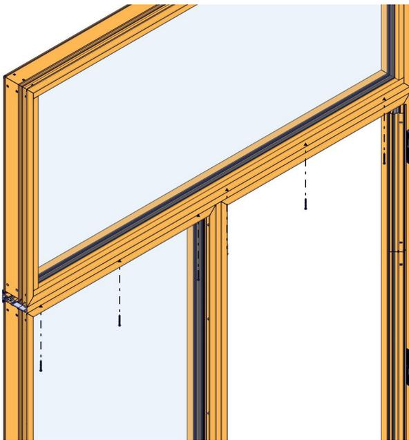
Instala el travesaño y el parteluz horizontal dentro del vano. Ajusta el marco de la puerta y la cabecera de la barra del parteluz utilizando tornillos #8 de 1 ¼".
