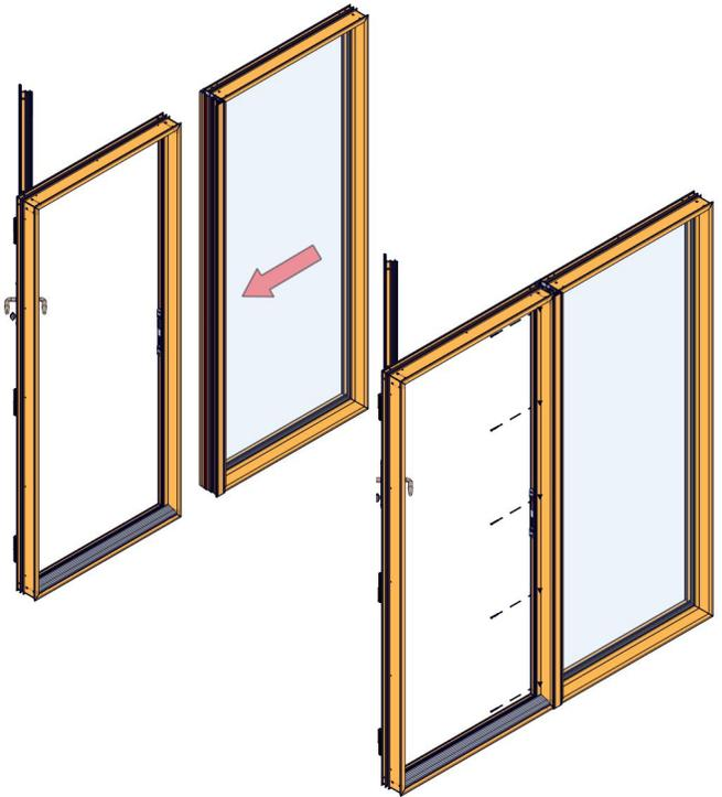
Instala los lados y la barra del parteluz dentro del vano. Ajusta el marco de la puerta con el parteluz utilizando tornillos #8 de 1 ¼".
