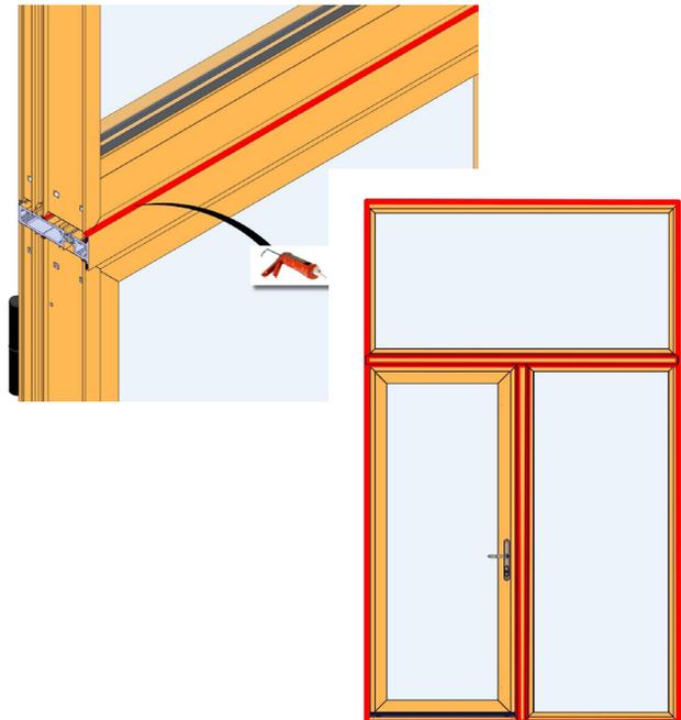
Calafatea todas las cuñas en el exterior del vano. instala nuevamente todos los topes de los vidrios cuando el ajuste se haya completado.
