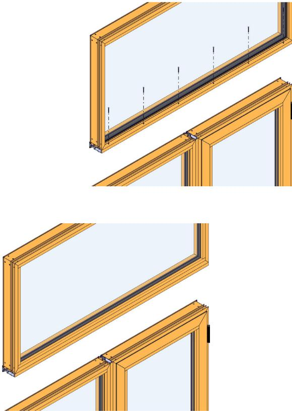
Ajusta el parteluz al travesaño utilizando tornillos #8 de 1 ¼". Instala nuevamente los topes del vidrio.
