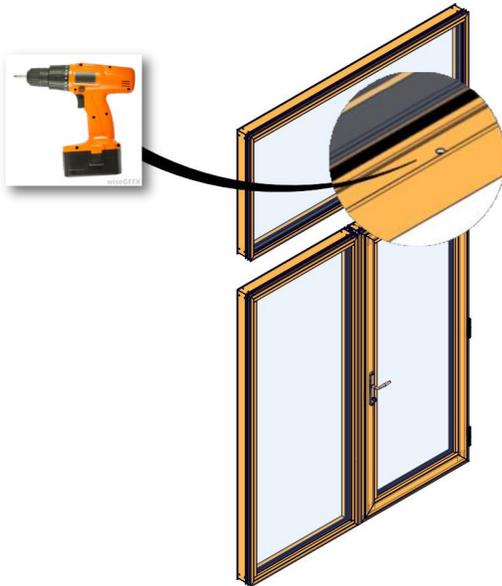
Remueve la barra y posteriormente los toques del vidrio inferior del travesaño. Perfora la jamba con brocas #8 para instalar el parteluz #57588 con 3" de arriba hacia abajo y 16" en el centro posteriormente.
