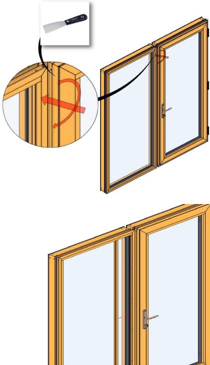
Instala la puerta con bisagras en el vano de acuerdo a los estándares del manual instalación. Instala sujetadores a través de la jamba de la puerta para mantener la puerta en su lugar. Remueve la barra y después los topes del vidrio superior de los lados utilizando una espátula.
