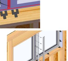
Aplica sellante en el inferior a 6" del centro del parteluz en T cubriendo el área completamente como se indica en la imagen.
