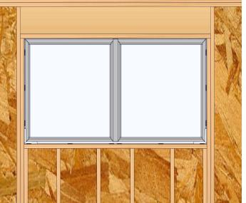
Inserta la placa de cobertura del parteluz sobre la placa base para finalizar el interior del parteluz.
