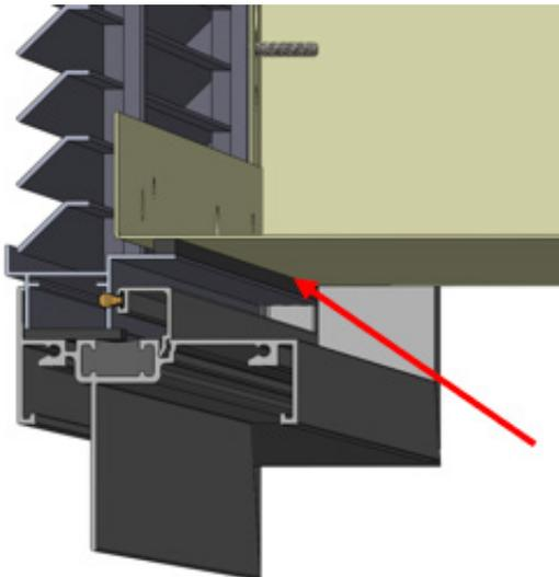
Revisa la alineación de los sujetadores de la montura, y la distancia alrededor del perímetro de la manga, y aún más importante, que haya contacto continuo en el inferior de la manga de la cuña encintar en el marco.
