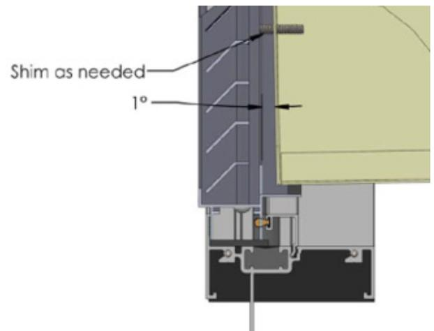
Si la unidad no está bien equipada con el desagüe exterior, añade el tubo del desagüe y cubre de acuerdo a las recomendaciones del fabricante. Nota: podrá ser necesario remover una barra de una de las cuchillas para el tubo de drenaje. Acuña tanto como sea necesario asegurando que la manga PTAC tenga una pendiente de 1 grado en el inferior hacia el exterior del drenaje.
