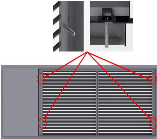
Localiza e instala los clavos de la montadura de la manga (si es que no se encuentran en el sitio). Inspecciona el perímetro sellando las pestañas y limpiando de acuerdo a las recomendaciones del fabricante del sellante.
