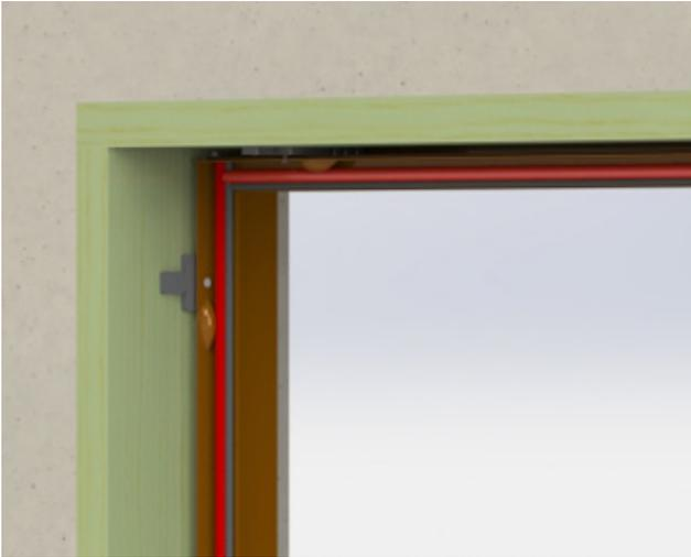
Haz un respaldo de sellante en el vinil del panel justo antes de insertar la ventana, o sellar la ventana con tapa con la unión del marco del panel desde el exterior después de que la ventana sea instalada. Cualquiera de los métodos que se utilice, la ventana debe estar sellada en húmedo al panel. El vinil del panel no es un sellante adecuado. Aísla alrededor del perímetro entre el sistema de panoramización y la pared.
