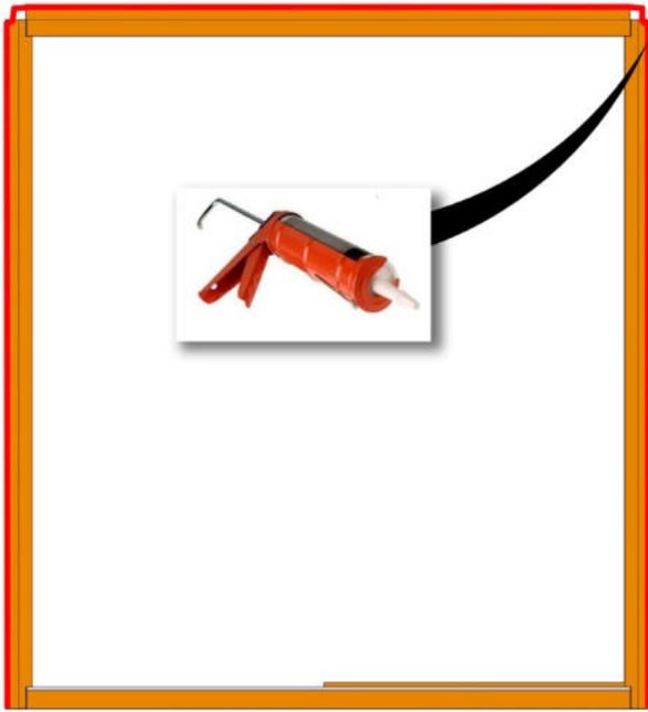
Aplique un cordón continuo de sellador de 3/8" de diámetro a lo largo de la parte posterior de la brida de clavado. El cordón debe rodear ambos lados y atravesar la cabeza, en línea con los orificios de la brida de clavado y cubriéndolos completamente.
