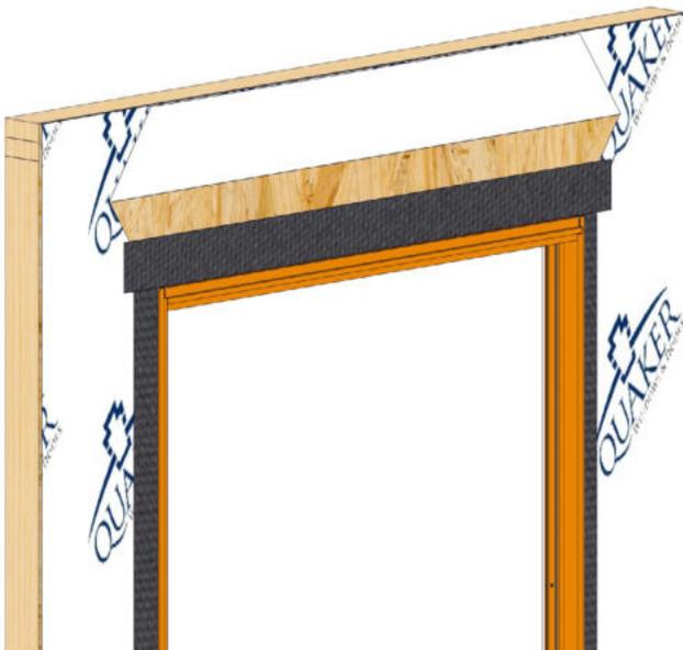
Aplique un cordón de sellador de 3/8" en el borde exterior superior del marco de la puerta antes de instalar la tapa de goteo.
