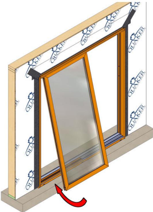
Incline el panel fijo con la parte superior insertada en el riel del cabezal y, a continuación, levante y coloque la parte inferior del panel en la extrusión del panel fijo en el alféizar.
