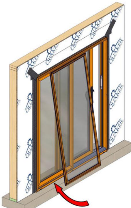
Incline el panel de la pantalla con la parte superior insertada en el carril del cabezal, y luego levante y coloque los rodillos inferiores en el carril de rodillos. Ajuste los rodillos según sea necesario para asegurar que el panel esté nivelado, cuadrado y se deslice suavemente.
