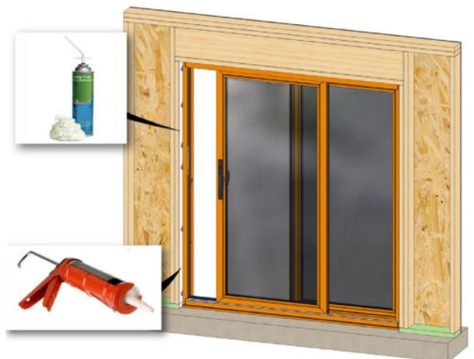
Rellene 1/3 interior de la cavidad con espuma de baja expansión o varilla de soporte y aplique el sellador de forma continua alrededor de todo el perímetro de la abertura.
