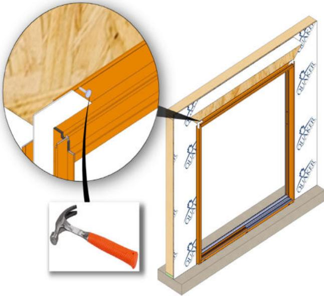
Fije temporalmente la puerta en su sitio utilizando clavos de tejado galvanizados de 2" a través de los agujeros preperforados en una de las esquinas superiores de la brida de clavado.
