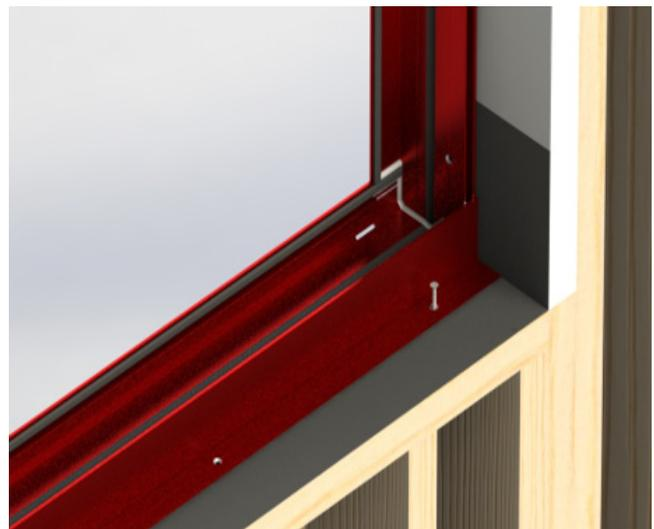
Centra e instala el sistema de reborde dentro del vano. Empuja y presiona el sistema hacia el interior asegurándote que el reborde se encuentre ajustado con el WRB. Atornilla temporalmente la ventana en su lugar usando un tornillo a través de los agujeros taladrados en el alféizar inferior. NO atornilles a través del reborde.
