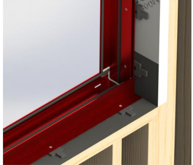
Aplica sellante en los agujeros de instalación o en los tornillos. Ajusta el sistema de reborde al marco con tornillos de acuerdo a los planos técnicos o cálculos de anclaje.
