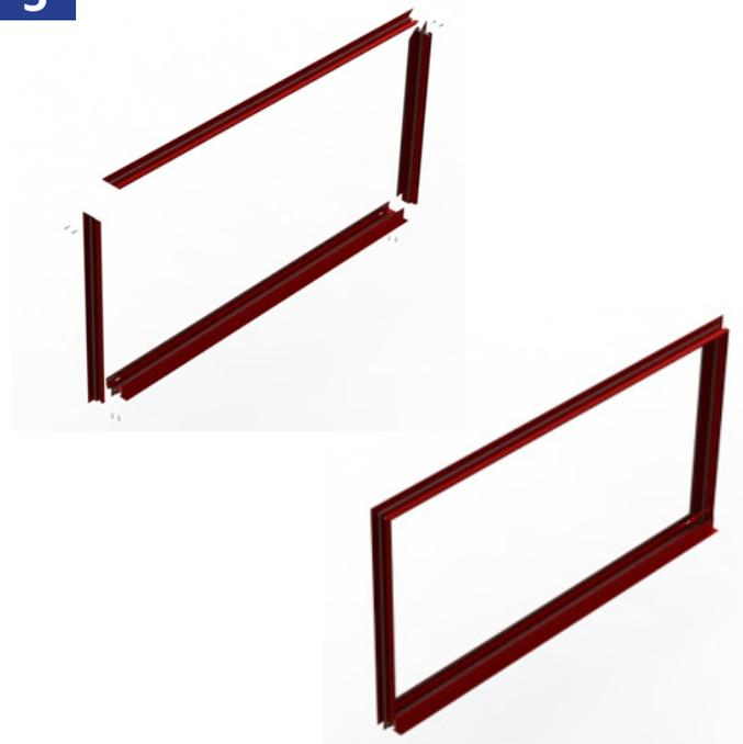
Ensambla las cuatro partes con los tornillos provistos usando un total de 8 tornillos.
