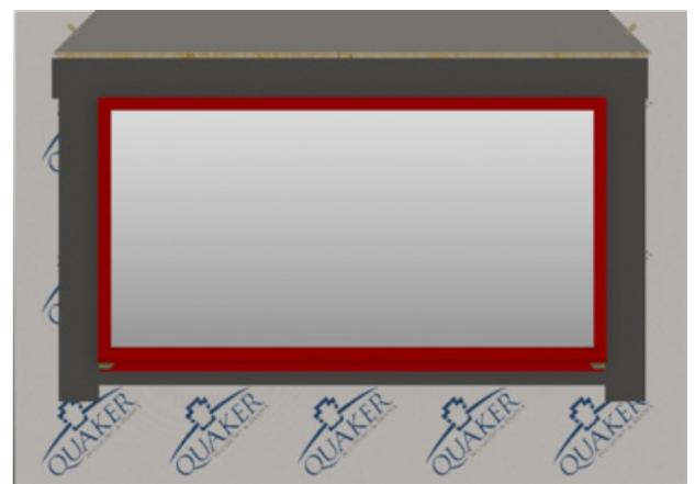
Corta una pieza de impermeabilizante para la cabecera y que se extienda más allá de los bordes exteriores de las jambas. Remueve el papel posterior e instala completamente cubriendo las monturas y añadiendo a la madera expuesta o piezas del marco.
