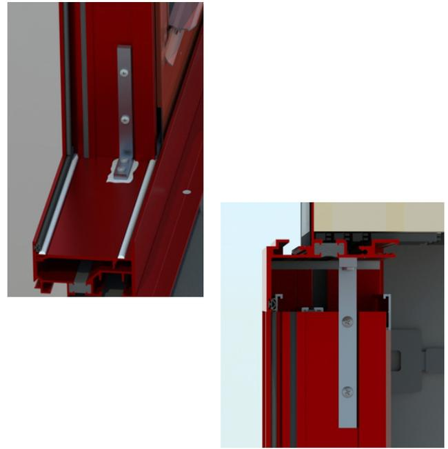
Instala los ángulos en "L" en una capa de sellante con tornillos taladradores. Nota: asegúrate que los tornillos no penetren en el alféizar inferior. Instala las otras ventanas siguiendo los pasos 22 y 23.
