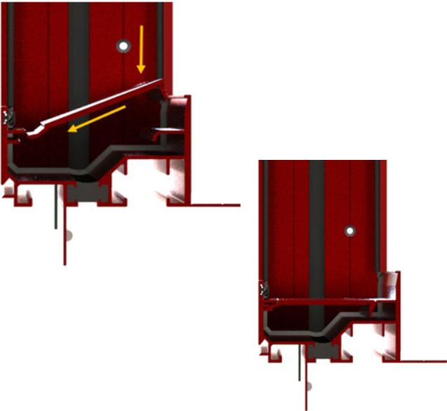
Instala la placa de anclaje de 8" en el centro del parteluz en un ángulo que tenga contacto corredizo con la pata dentro de la muesca en el alféizar inferior, presiona la placa de anclaje para abajo hasta que encaje en su lugar.
