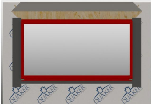
Corta dos piezas de impermeabilizante para cada jamba extendiendo 1" sobre el reborde y 4" a 6" por debajo del borde del alféizar. Remueve el papel posterior y presiona fijamente en los lados del marco de la ventana.
