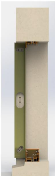
Corta la cabecera del receptor en cuadrado y aplica el clip de  $\frac{1}{2}$ " menos que la apertura horizontal permitiendo una unión geométrica. Ajusta la banda de clima en la longitud apropiada siendo cuidadoso de no estirar demasiado el material. Usa el guion gráfico o el borde recto para nivelar desde el alféizar inferior para localizar la locación de la cabecera del receptor.
